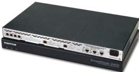
La gamme SmartNode 2400 offre une liaison haute densité et transparente entre le réseau téléphonique à commutation de circuits et la voix sur IP. Idéale pour accéder aux opérateurs multiservices et au réseau RTPC d'entreprise, la gamme SmartNode 2400 supporte 120 appels en mode voix par paquets. Équipés de deux ports Ethernet 10/100 et quatre ports d'interface voix, les SmartNode 2400 se connectent à n'importe quel commutateur, PBX ou réseau de données.
