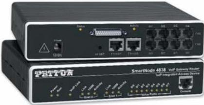
Les boîtiers IAD de la gamme SmartNode™ 4830 vous permettent de bénéficier de la voix sur IP sur pratiquement tout type de liaison d'accès WAN. Les modèles de cette gamme sont équipés de deux à huit ports téléphoniques analogiques FXS et de deux ou quatre ports FXO. Chaque modèle dispose de deux ports Ethernet ainsi que d'un modem WAN intégré — utilisez au choix les ports X.21, V.35, T1, E1, G.SHDSL ou ADSL2+ selon vos besoins. Au nombre des fonctions
