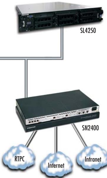
Le PBX IP de Patton, la famille de passerelles analogiques et TGW RTPC SmartNode, et les téléphones VoIP SIP forment ensemble une solution PBX pour l'entreprise. Ils peuvent être achetés séparément ou sous la forme d'un système clé en main.
