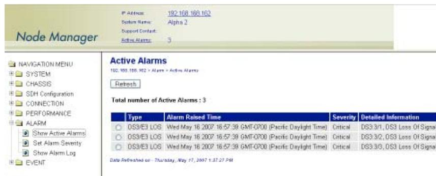
Figure 98. Displaying DS3/E3 Port Alarms
