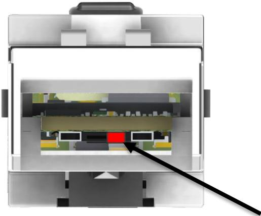
**FIGURE 3.1 SFP MODEM REAR VIEW, SWITCH IS IN THE RIGHT POSITION (FACTORY DEFAULT).**
