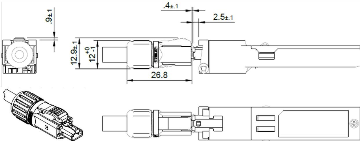
FIGURE 4.6 CL-SFP/SPE WITH CONNECTOR MSPE-P2L0-2A0XX
